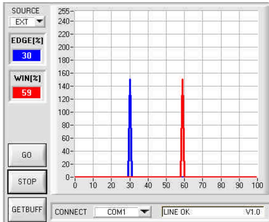
Um den Sensor mit einem Aktivfenster zu betreiben, müssen zwei Initiatoren dem Sensor die Aktivzeit mitteilen. Wie oben beschrieben öffnet man das Aktivfenster mit einer positiven Flanke an dem Eingang IN0 und schließt dieses wieder mit einer positiven Flanke am Eingang IN1.
