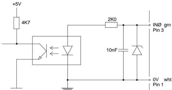
Abb. 4: INØ-Synchronisationseingang für Messung TRIGGER (siehe Softwarebeschreibung)
