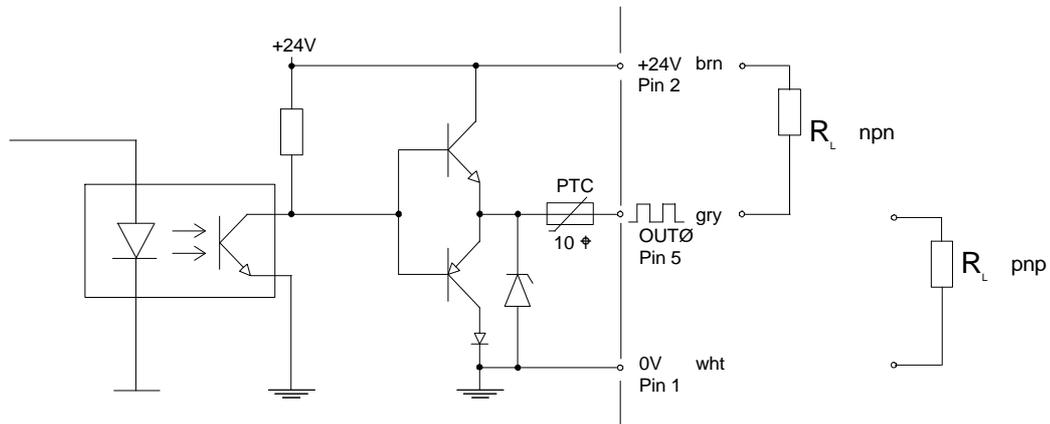
Abb. 2: OUTØ - Ausgang 100mA max. (Zählimpuls)
